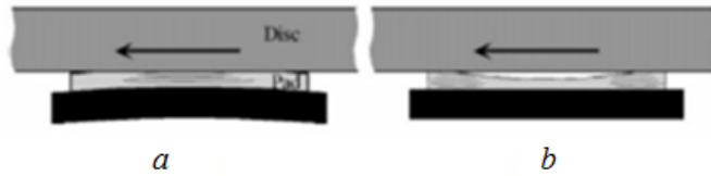
Şəkil 2. Üzlüyün və arxa divarın qızması zamanı xarici qabarıq əyilmə (a), temperatur aşağı endikdə əyilmə halındakı homogen olmayan aşınma (b)
